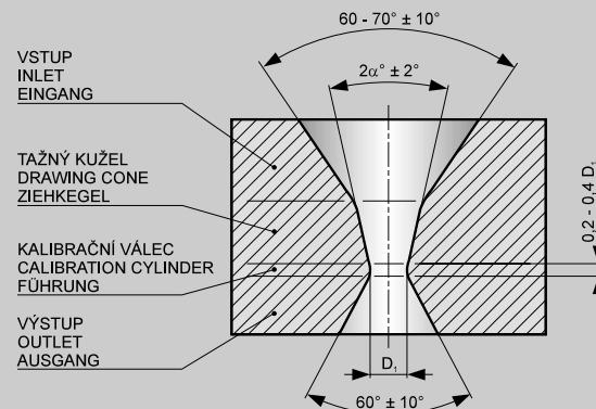
Hodnoty na obrázcích specifikují geometrii průvlaku před opracováním na konečný tvar a rozměr.
