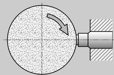
Chladící kapalinu nasměrovat na čelo orovnávače a přivádět ji již před započetím orovnávání.
