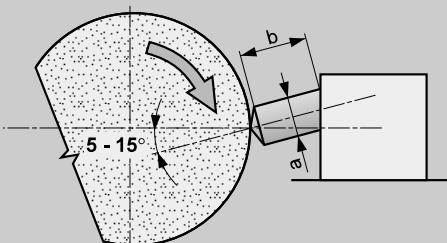
Je nutné dodržovat doporučenou hloubku řezu (0,025 - 0,03 mm). Větší hloubky řezu vyvolávají přehřátí diamantu a jeho rychlejší opotřebování. Posuv do 0,2 mm/ot..
